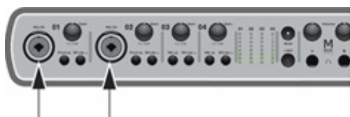
Mbox Pro DI Inputs 1 and 2
