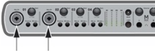
Mbox Pro DI Inputs 1 and 2
